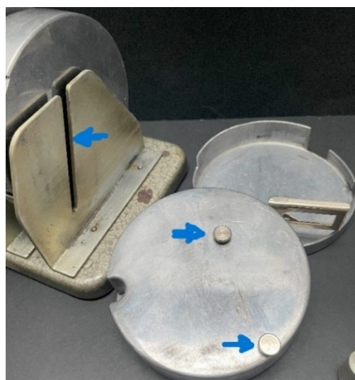
Abb. 3: Rückseitige Schale mit Zapfen zur Fixierung am senkrechten Blech des Ständers
