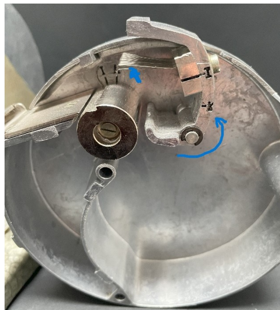
Abb. 5: Halbschale mit geöffnetem Bügel (oben rechts) zum Herunterdrücken der Marken
